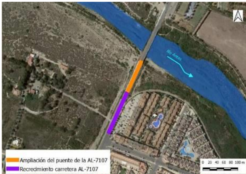
Figura 7. Ampliación del puente de la AL-7107 y recrecimiento de la carretera
