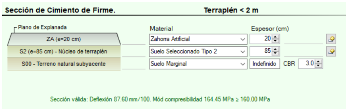
Figura 11. Sección del cimiento del firme proyectada
