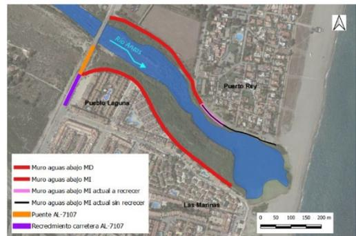
**Muro sobre la mota de la margen derecha:** Se desarrolla sobre esta mota a lo largo de 620 m –en sus últimos 100 m la mota existente tiene altura suficiente y no precisa recrecimiento alguno–; la altura de muro es variable, resultando una media de 1,10 m y máxima de 2,35 m.
