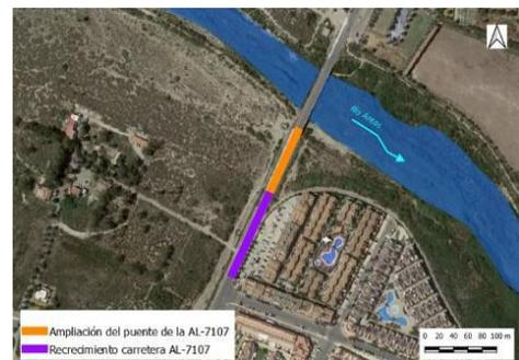
Antes de la ejecución de esta ampliación deberá explanarse el entorno, retirando el material que conforma el terraplén en el tramo ocupado por esta nueva estructura y excavando el terreno natural para permitir el flujo bajo ella. La cota del terreno bajo la ampliación del puente será la 3,20 msnm, dejando una altura libre de 3,30 m hasta la cara inferior de las vigas del tablero.
