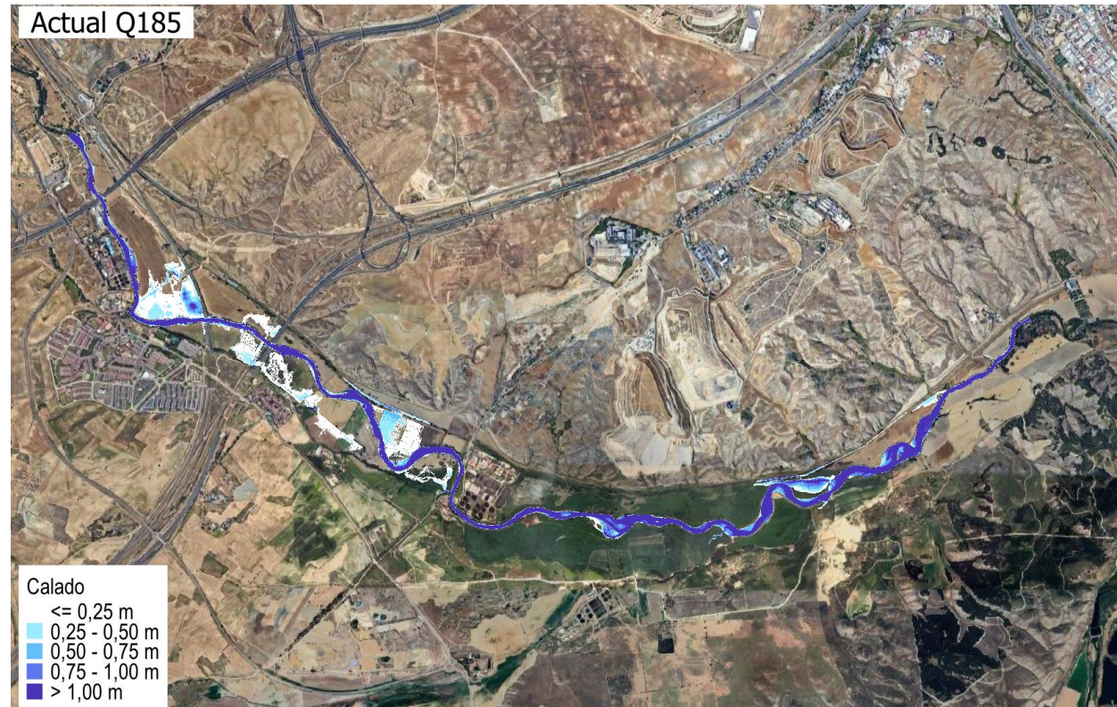
Figura 45. Situación Actual. Envolvente de calados para el caudal de 185 m 3 /s (T = 10 años)
