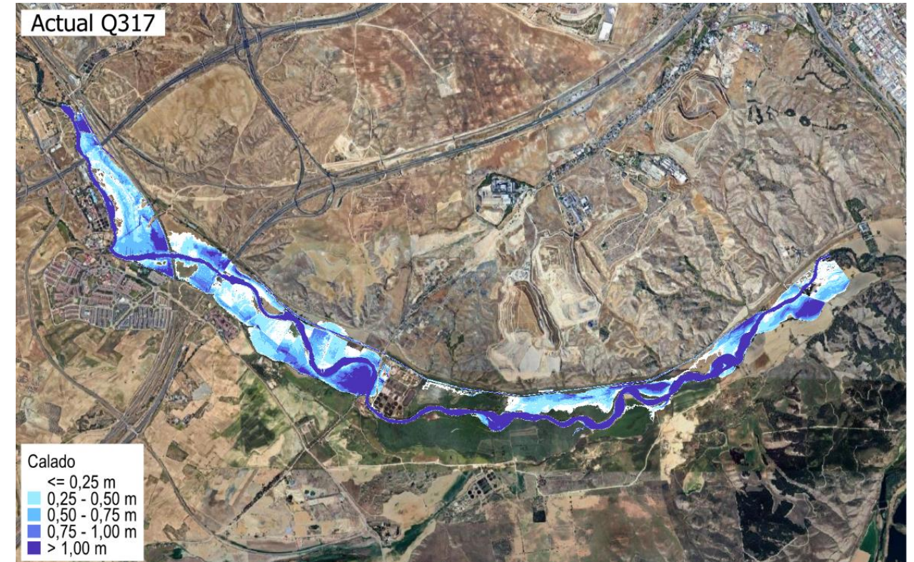
Figura 47. Situación Actual. Envolvente de calados para el caudal de 317 m 3 /s (T = 50 años)
