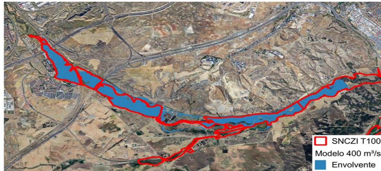
Figura 12. Envolventes de período de retorno 100 años del SNCZI y del modelo de 400 m³/s realizado para el presente proyecto
