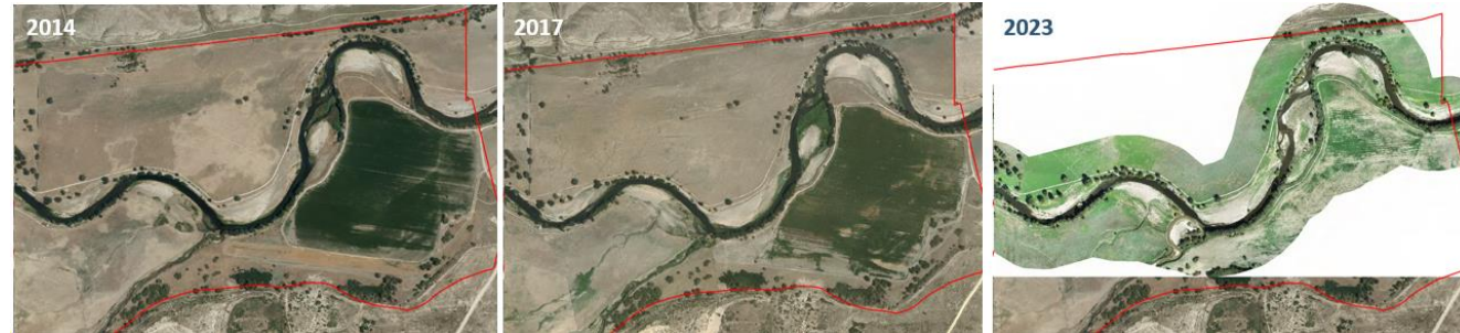
Figura 19. Evolución en planta del cauce principal del río Manzanares en el entorno de la desembocadura del Arroyo Culebro.
