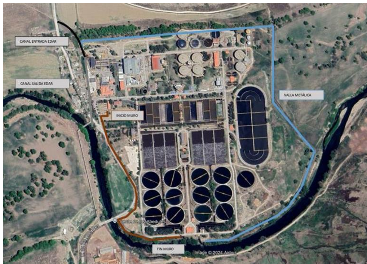
Figura 10. Tipos de muros de la EDAR Sur
