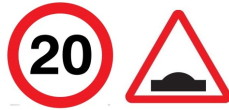
Figura 10 Detalle de señales (R-301 20 km/h y P-15a) a ubicar antes del baden en ambos sentidos.
