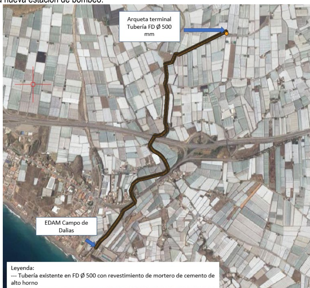
Trazado de tubería existente en fundición Ø 500 mm k-9.
