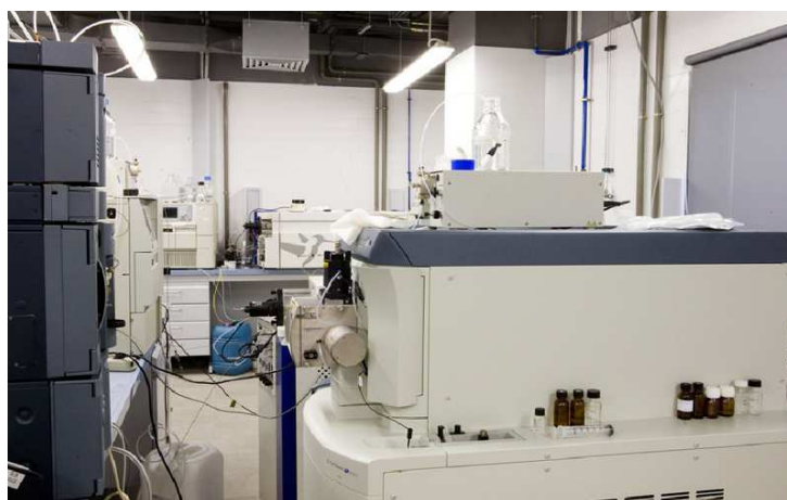
Figura 3. Equipo UPLC-(Q)TOF MS utilizado
