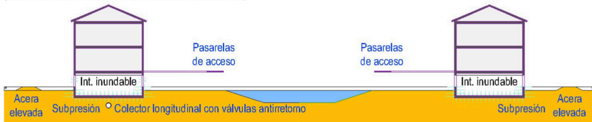
Figura 11. Criterio de diseño: transparencia hidráulica y protecciones en parcela.
