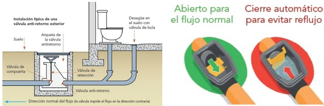
Fig. 50: Válvula antirretorno. Guía para la reducción de la vulnerabilidad de los edificios frente a las inundaciones. Dirección General del Agua y Consorcio de Compensación de Seguros. 2017.
