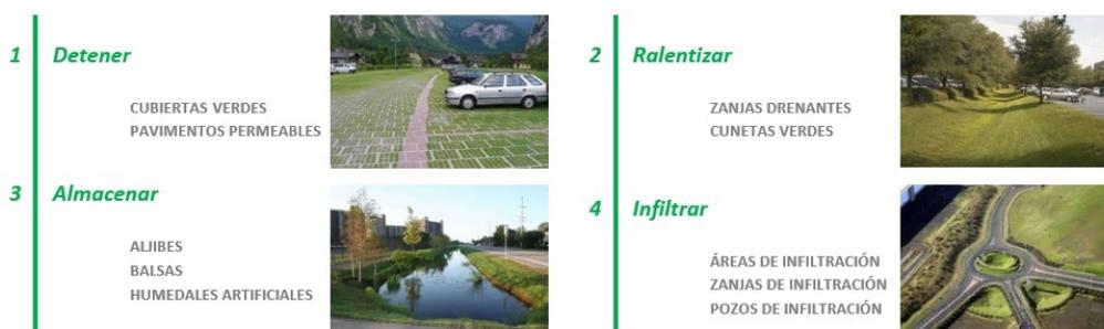
Fig. 54: Tipología de SUDS. Guías de adaptación al riesgo de inundación: sistemas urbanos de drenaje sostenible. 2019.
