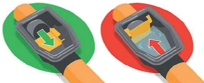
Fig. 45: Válvula antirretorno. Guía para la reducción de la vulnerabilidad de los edificios frente a las inundaciones. 2017.
