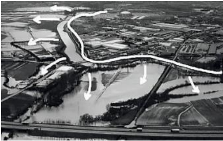
Fig. 69: Laminación de avenidas del río Zadorra y anillo verde interior. El anillo verde interior: hacia una infraestructura verde urbana en Vitoria-Gasteiz.
