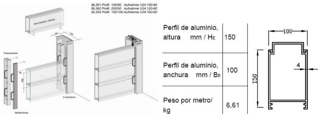
Fig. 58: Barreras temporales desmontables de aluminio. Modelo BL364. Blobel.
