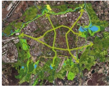
Fig. 69: Laminación de avenidas del río Zadorra y anillo verde interior. El anillo verde interior: hacia una infraestructura verde urbana en Vitoria-Gasteiz.
