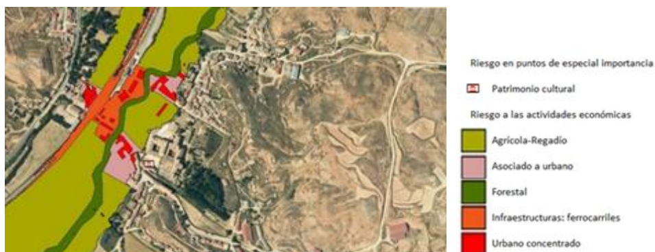
Fig. 04: Entorno del Monasterio de Santa María de Huerta: riesgo a las actividades económicas y puntos de especial importancia T=500. SNZCI. Ministerio para la Transición Ecológica y el Reto Demográfico.
