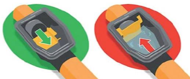
Fig. 51: Válvula antirretorno. Guía para la reducción de la vulnerabilidad de los edificios frente a las inundaciones.
