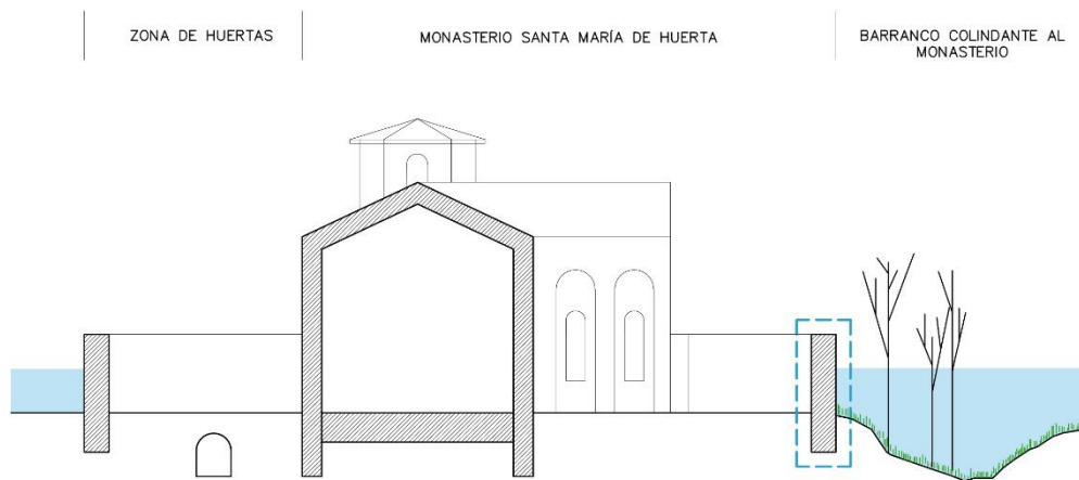
Fig. 36: Consolidación del muro exterior sudoeste.
