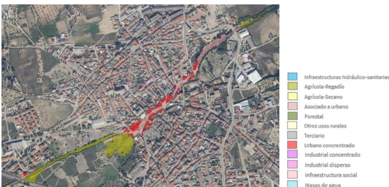
Fig. 04: Cebolla: Riesgo a las actividades económicas T=500. SNZCI. Ministerio para la Transición Ecológica.
