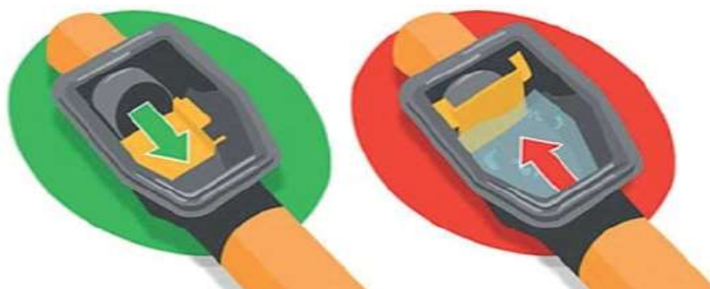
Fig. 34: Válvulas antirretorno. Guía para la reducción de la vulnerabilidad de los edificios frente a las inundaciones. 2017.
