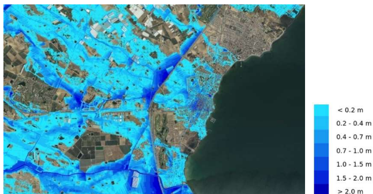
Fig. 03: Los Alcázares: peligrosidad T=500. SNCZI. Ministerio para la Transición Ecológica y el Reto Demográfico
