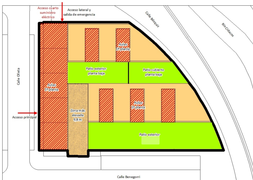
Figura 18. Diagrama de accesos al edificio y diferentes bloques del mismo: patios y aulas
