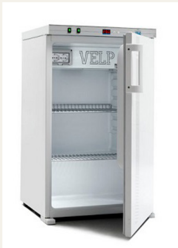
Figura 58. Incubadora refrigerada con rango de 5 a 50 °C. La de la izquierda tiene precisión de 0,5 °C. En muchos casos, es difícil conocer la precisión de la temperatura, pero es esencial. Imágenes extraídas de: https://shop.llg.de (izquierda) y https://www.velp.com (derecha).
