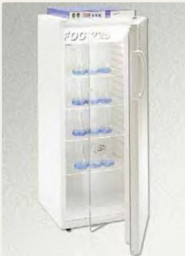
Figura 58. Incubadora refrigerada con rango de 5 a 50 °C. La de la izquierda tiene precisión de 0,5 °C. En muchos casos, es difícil conocer la precisión de la temperatura, pero es esencial. Imágenes extraídas de: https://shop.llg.de (izquierda) y https://www.velp.com (derecha).
