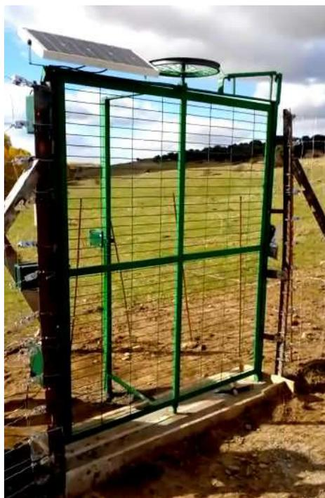
*Figura 8: Imagen de la puerta automática de entrada / salida al cercado de protección nocturna del ganado de recría. Puede construirse de manera esencialmente mecánica mediante un sistema de poleas o empleando un automatismo motorizado con un mayor consumo eléctrico que implicaría la necesidad de conexión a la red eléctrica, o en su caso dimensionamiento adecuado de placa fotovoltaica.*
