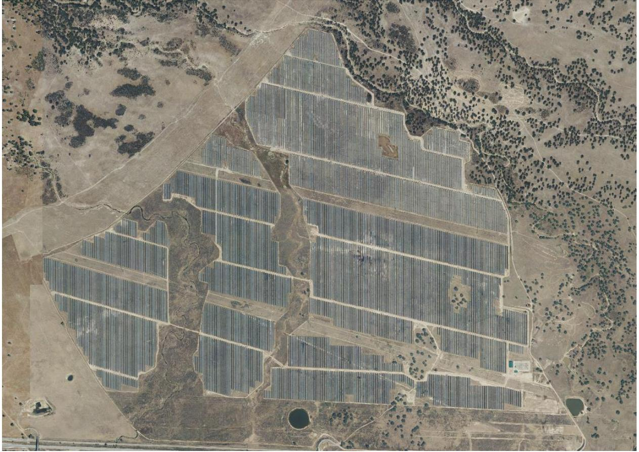
Figura 4-14. Apertura de corredores dentro de una planta solar fotovoltaica aprovechando vaguadas y puntos con arbolado.
