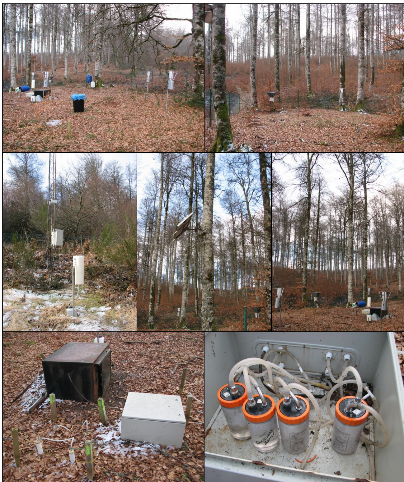
FIG 7: Parcela interior, acumuladores de deposición, captador de desfronde. Estación meteorológica. Lisímetros
