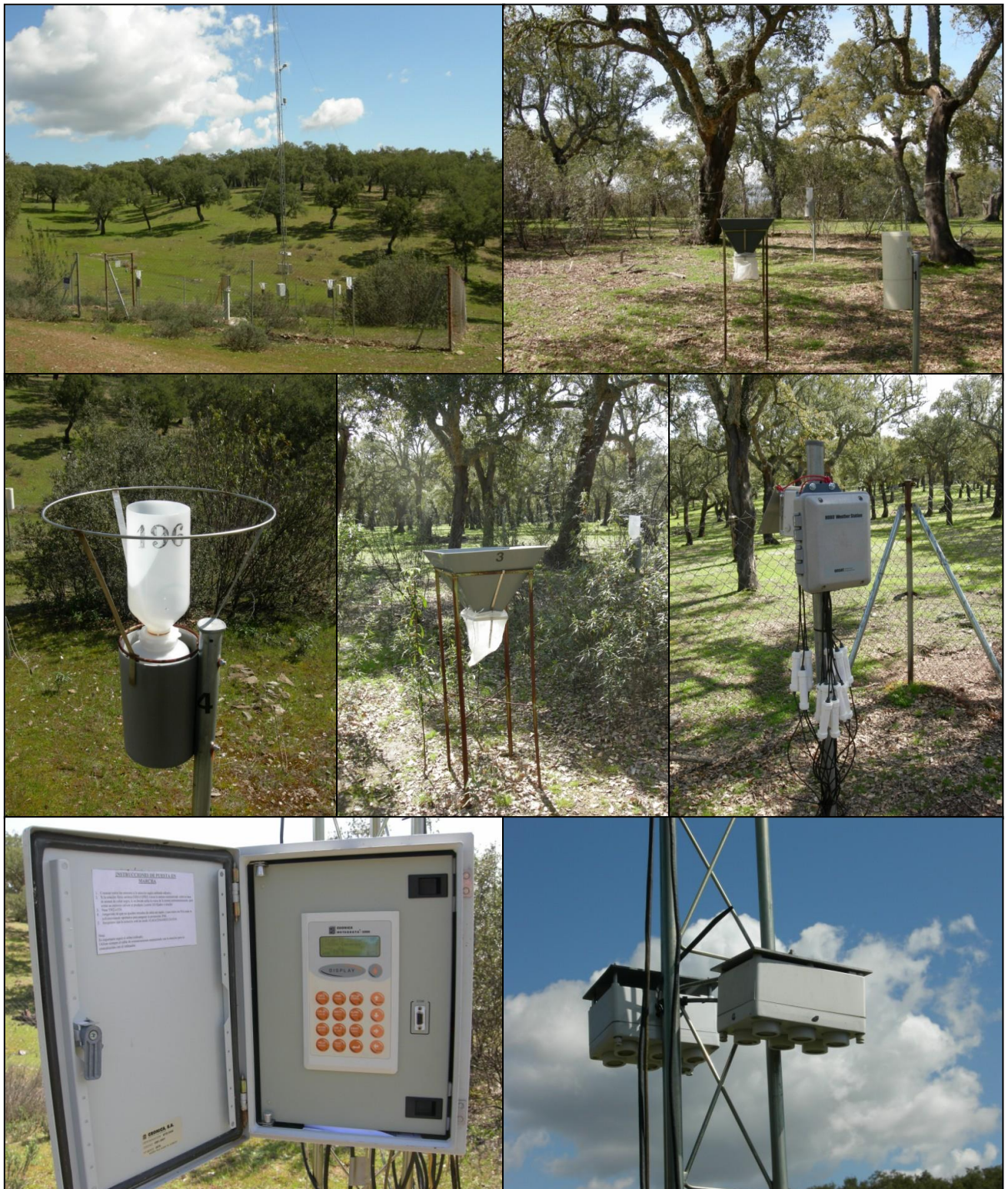
FIG 7: Parcela exterior. Torre meteorológica. Captador de desfronde y pluviómetro. Acumulador de deposición.. Sonda de humedad. Data-logger. Dosímetros pasivos
