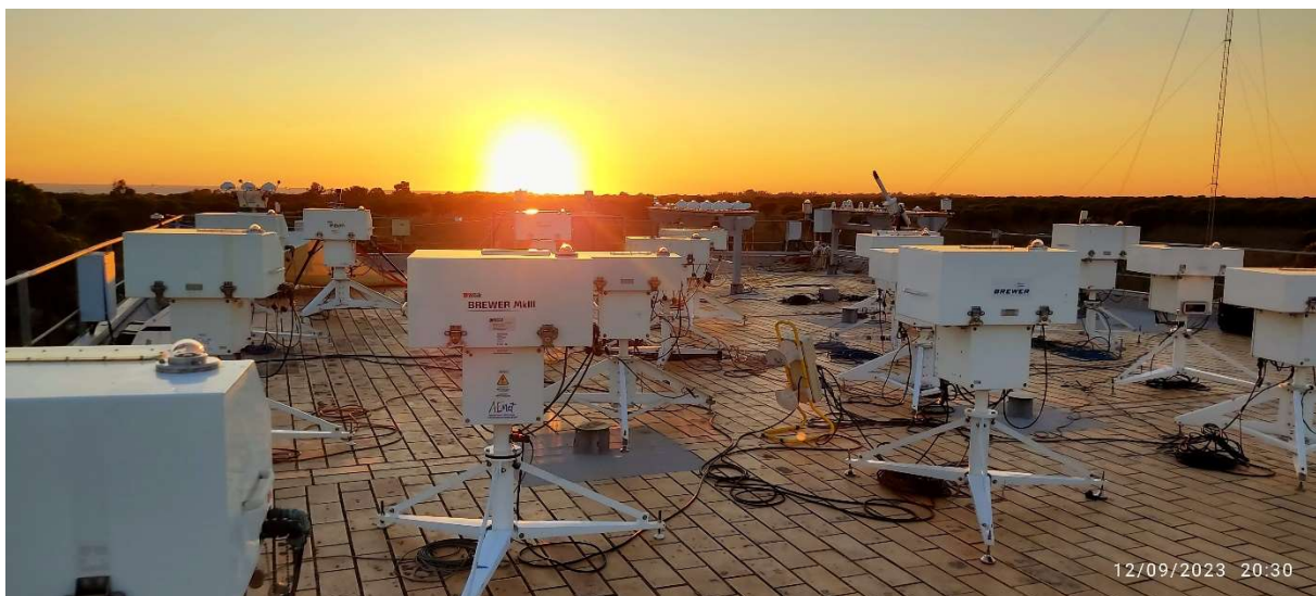
Terraza de la Estación de Sondeos Atmosféricos del INTA en El Arenosillo (Huelva), en primer plano los espectralradiómetros Brewer realizando las medidas durante la XVIII Campaña Internacional de calibración e intercomparación de instrumentos para la medida de ozono total y radiación solar ultravioleta celebrada recientemente.
