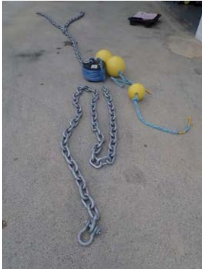
Figura 2-14 Ejemplo de línea de fondeo mixta (cabo y cadena) para despliegues en aguas someras.
