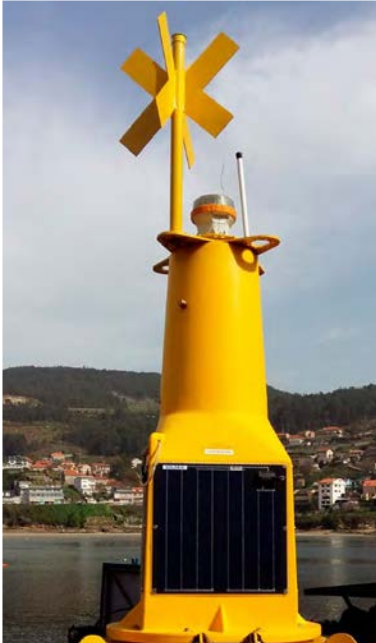
Figura 2-11 Torreta con bandeja auxiliar, preparada para soportar diversos elementos, como la lampara, la Cruz de San Andrés, antenas, etc.
