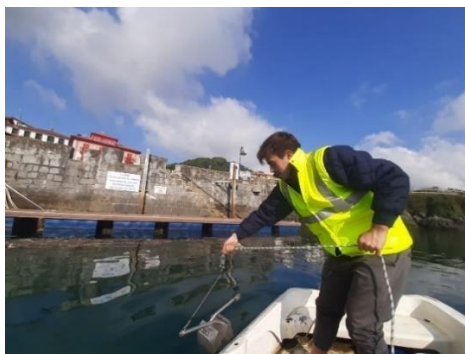
Figura 15. Toma de muestras mediante draga Van Veen.
