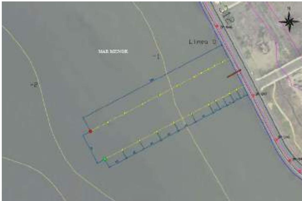
Ilustración 7: Canal balizado proyectado
