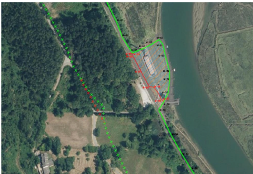
Imagen parcial de la zona. En verde deslinde y servidumbre de protección aprobados. En rojo deslinde y servidumbre de protección propuestos
