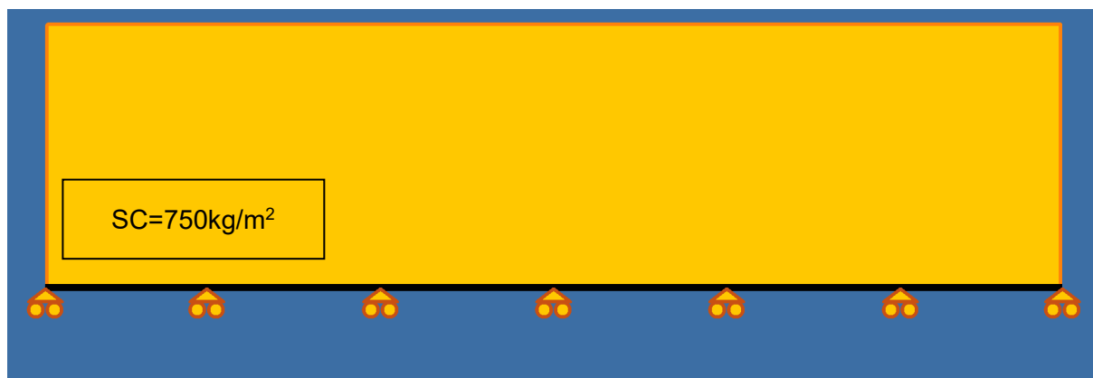
Ilustración 2. Esquema de la losa con las cargas por peso propio y sobrecarga de uso.
