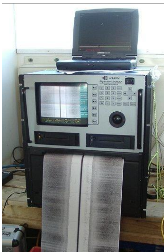
Figura 12. Registros del levantamiento morfológico realizado con Sonar de barrido Lateral.
