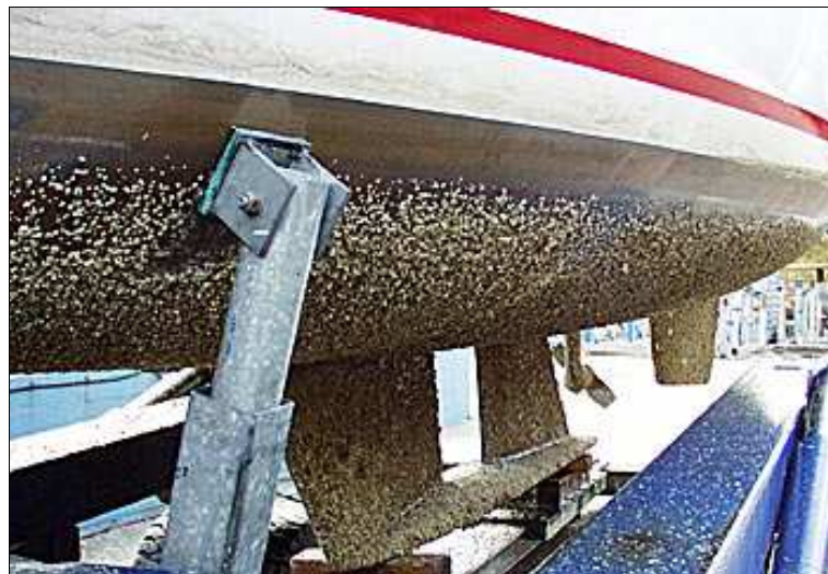
Figura 17. Casco externo del barco impregnado de fouling
