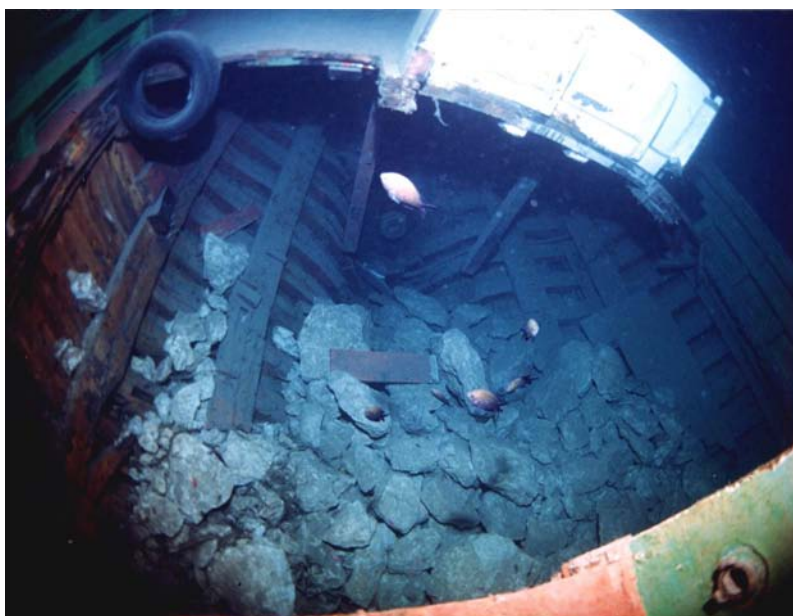
Figura 4. Los pecios de madera deben ser lastrados para garantizar su estabilidad.
