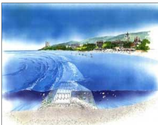
Figura 10. Protección de la línea de costa frente al oleaje mediante un arrecife artificial
