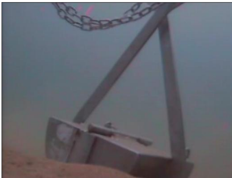
Figura 15. Draga tipo Van Veen con cierre hermético
