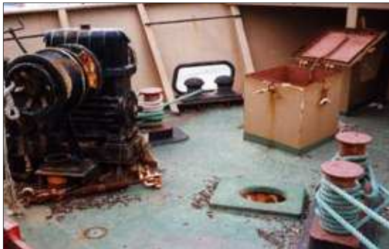
Figura 8. Sistema hidráulico de recogida de maroma
