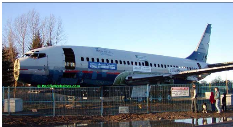
Figura 22. Estructura de avión lista para fondear como arrecife artificial
