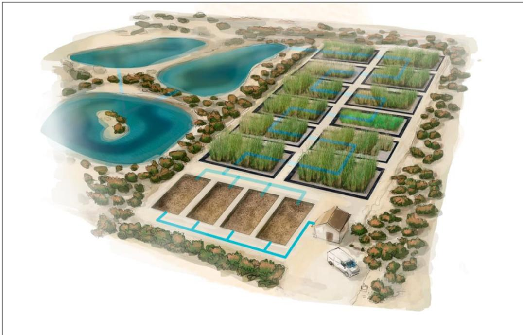
Figura 16. Esquema genérico de un Filtro Verde.
