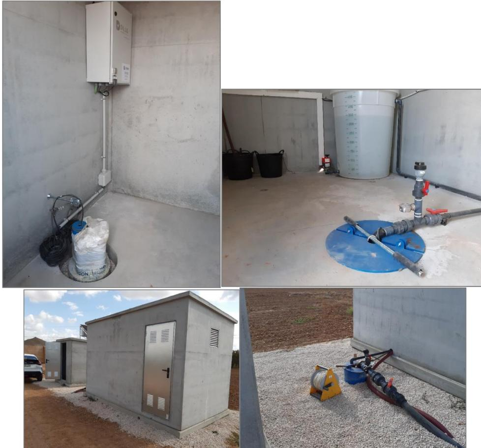
Figura 34. Sondeos y equipos de medida. Arriba izqda.: sondeo con la primera sonda de medida de nitratos en continuo instalada; arriba dcha.: sondeo que albergará los mini laboratorios portátiles; abajo izqda.: vista exterior de las casetas en cuyo interior se ubican los sondeos y equipos de medida; abajo dcha.: pozo de bombeo para movilizar las aguas del acuífero de manera previa a las mediciones.
