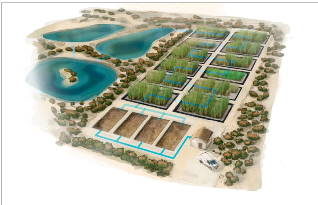
Figura 18. Esquema genérico de un Filtro Verde.
