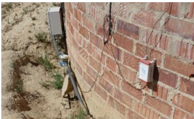
Imagen 2. Instalación con lectura automática y transmisión de datos en tiempo real en uno de los pozos integrados en el sistema "Doñana 4.0", de una de las explotaciones dedicadas al cultivo de frutos rojos (moras) en la Comunidad de Regantes de El Condado (Huelva).
