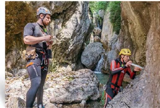
*Medida de la dureza de la roca mediante un esclerómetro en el barranco de Angonés (tramo superior)*
