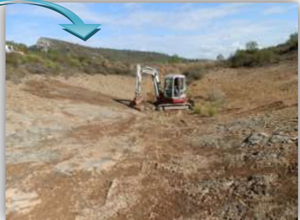
Máquina en labores de limpieza, y ahoyado mecánico para la plantación
